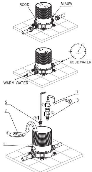
Controleer of het inbouwdeel waterdicht is,
